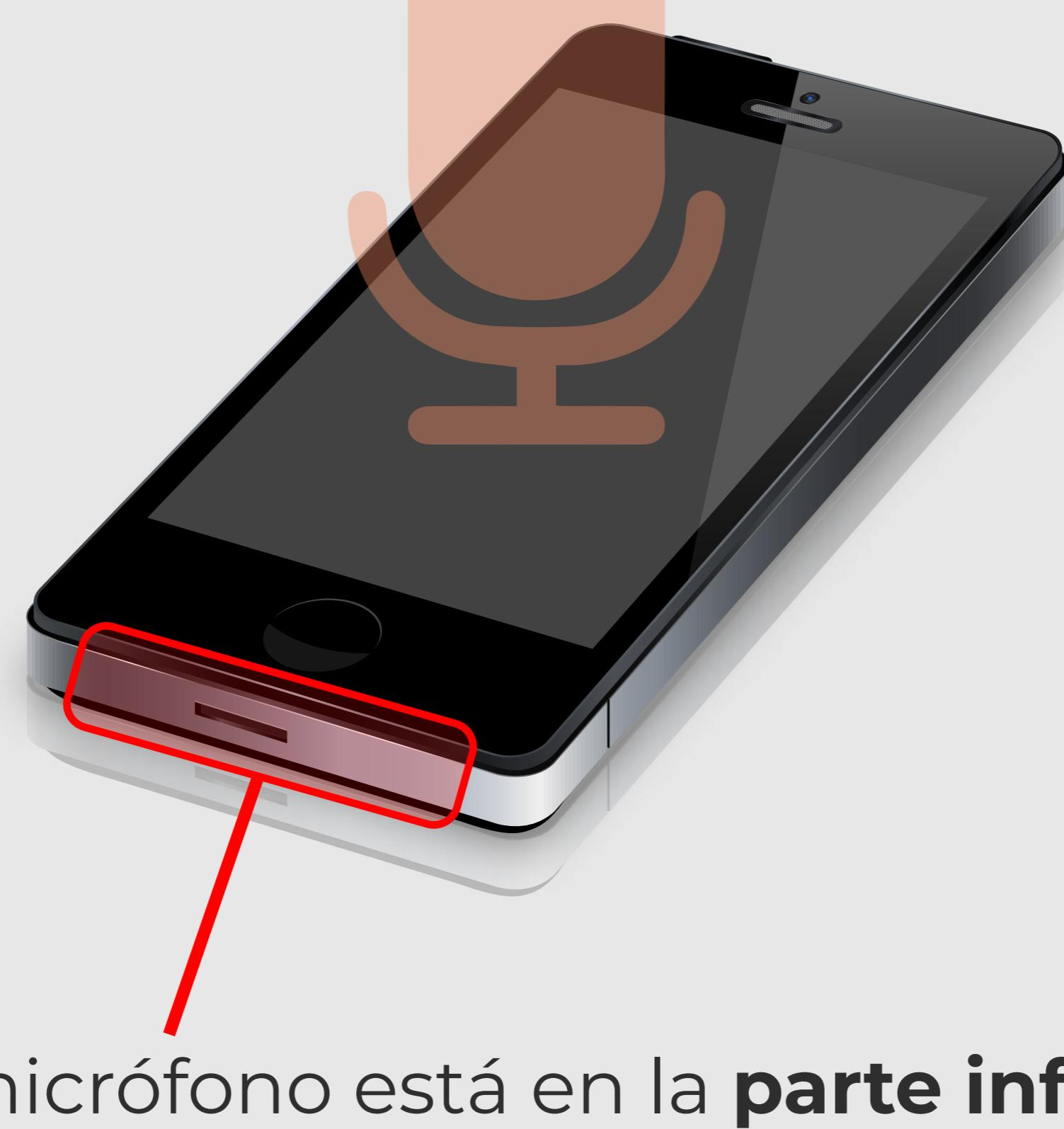
El micrófono está en la **parte inferior del teléfono**, cerca del puerto de carga. Lo utilizas para hablar en llamadas o grabar notas de voz.
